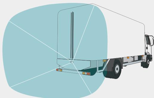
Vertikale Ausrichtung der Kamera: Je nach Anbauhöhe und gewünschtem Darstellungsbereich gilt es, die passende Kamera und Öffnungswinkel zu wählen. Sollen Details wie eine Anhängerkupplung o.ä. gut sichtbar sein, empfehlen wir einen kleinen Öffnungswinkel.
